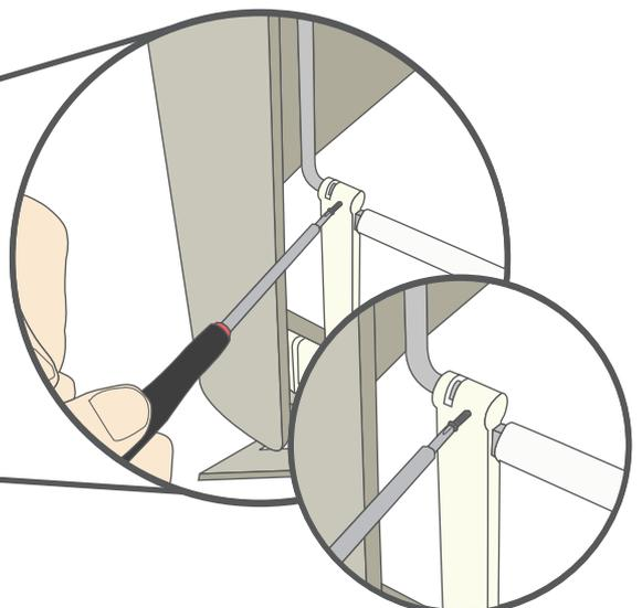
**5** Con la parte superiore del telaio completamente alzata inserire una vite nel foro sul lato destro del telaio.
